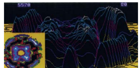
AIX.2 Darstellungen der gesamten Membran bei einer einzigen Frequenz. Oberes Bild bei niedriger Frequenz, unteres bei hoher Frequenz. Anmerkung: 4-fache Symmetrie und weiches Schrumphen des zentralen Bereichs
